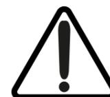
アンプの出力端子の横に印刷されている感嘆符は、「CLASS 2 WIRING (クラス2の配線)」の文字に加えて、危険な電圧のリスクをユーザー様に警告するためのものです。危険をもたらす可能性のある出力コネクタには感嘆符が付けられています。アンプの電源が入っている間は、出力端子に触れないでください。アンプの電源を切った状態で、すべての接続を行います。
