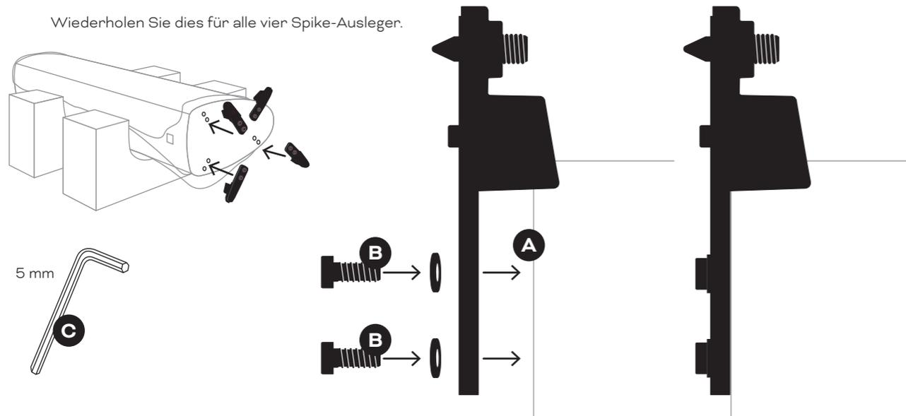
**6** Befestigen Sie die beiden magnetischen Spike-FüÙe **A** an den Spike-Auslegern **B** an der oben liegenden Seite des Lautsprechers.
