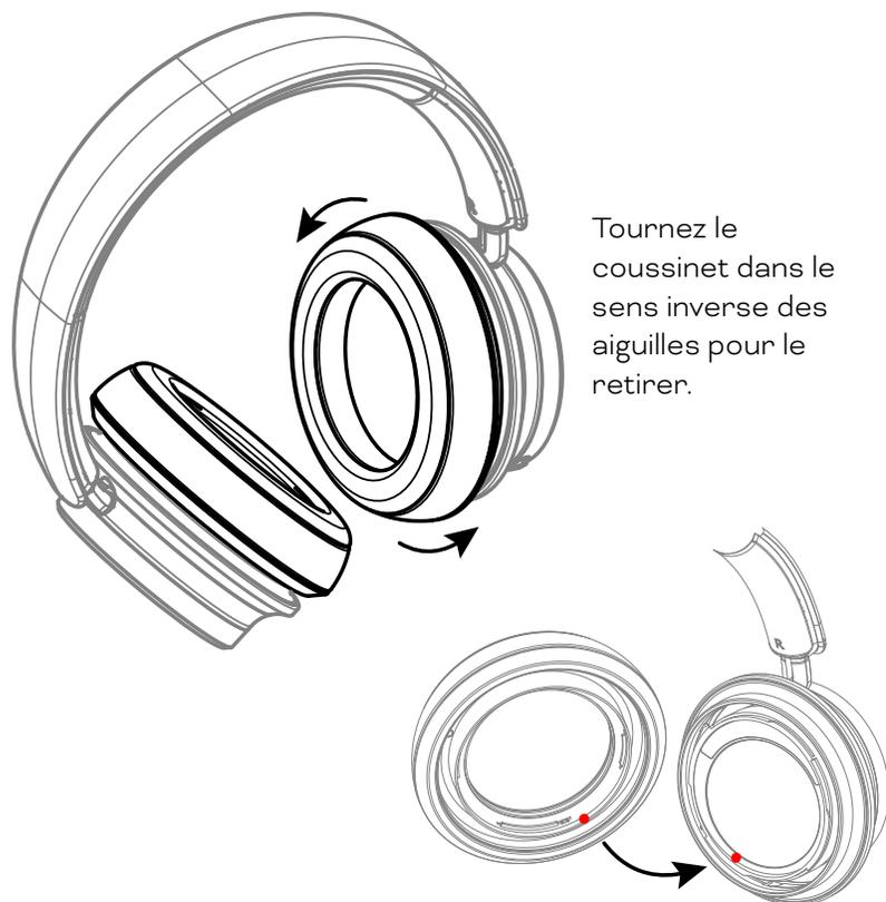
Tournez le coussinet dans le sens inverse des aiguilles pour le retirer.
