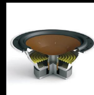
**Holzfasermembranen** | Sowohl die kleineren 130 mm- als auch die exklusiv bei der ZENSOR 7 eingesetzten 180 mm großen Tieftieftöner besitzen vierlagrige Schwingspulen für einen optimalen Antrieb der Holzfasermembranen. Die auf minimale Verluste ausgelegte Chassiskonstruktion mit ihrem steifen Metallkorb und dem akribisch eingepassten Konus sichert eine gut kontrollierte, detaillierte Basswiedergabe und ein exzellentes Ein- und Auswingsverhalten.
