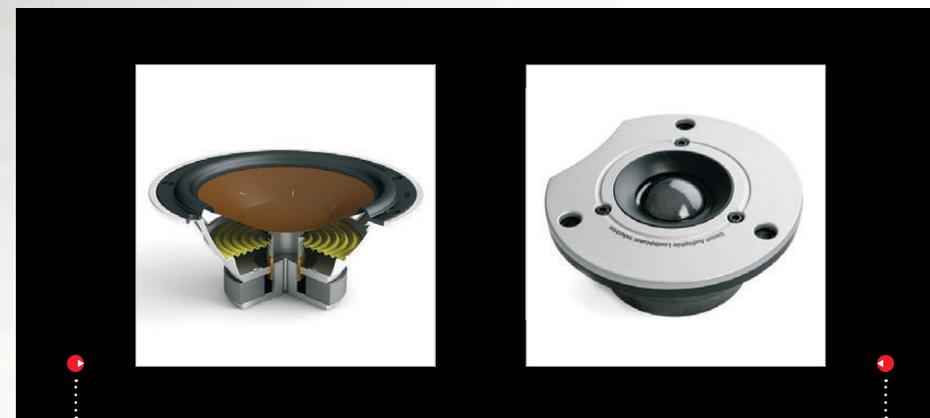
Die bei der ZENSOR AX Serie eingesetzten 130 mm großen Tiefmitteltöner besitzen vierlagige Schwingspulen für einen optimalen Antrieb der Papier-/Holzfasermembranen. Die auf minimale Verluste ausgelegte Chassis-konstruktion mit ihrem steifen Metallkorb und dem akribisch eingepassten Konus sichert eine gut kontrollierte, detaillierte Ein- und Ausschwingverhalten.
