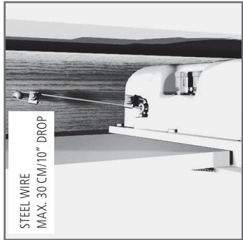
Nedfaldssikringen i form af stålwire, der er forsvarligt fastgjort mellem bærende bygningsdele og øjerne på DALI IKON PHANTOM sikres, så den kan holde højttalerens vægt ved fald. Dette er særligt vigtigt ved montering i loft, hvor nedstyrning af højttaleren kan være forbundet med livsfare!
