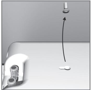
På bagsiden af DALI IKON PHANTOM er der et hul, der har form som et nøglehul. Dette giver mulighed for, at DALI PHANTOM forsøgsvis kan hænges op på en skrue, uden at save hul i væggen. OBS: Anvend en skrue, som kan bære højttalerens vægt og vær sikker på, at skruen monteres forsvarligt i væggen. Diametren på skruens hoved må maksimum være 9 mm.
